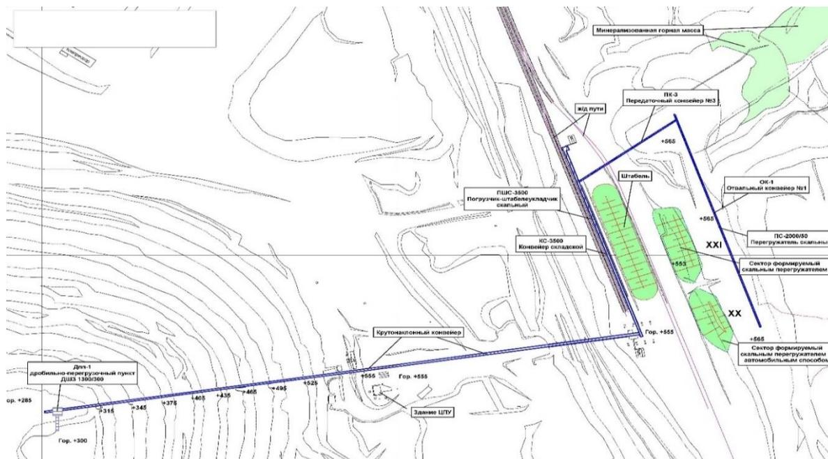
**Рисунок 1.** Работа комплекса ЦПТ-руда с КНК с дополнительной конвейерной линией на поверхностный склад.
