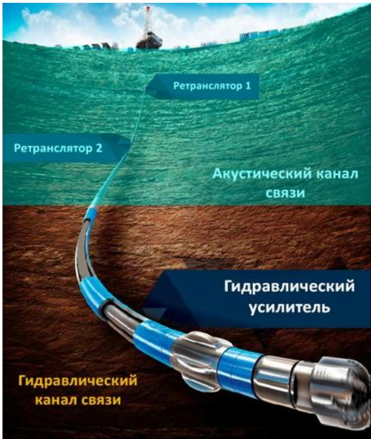
Рисунок 1. Комбинирование гидравлического и акустического каналов связей
