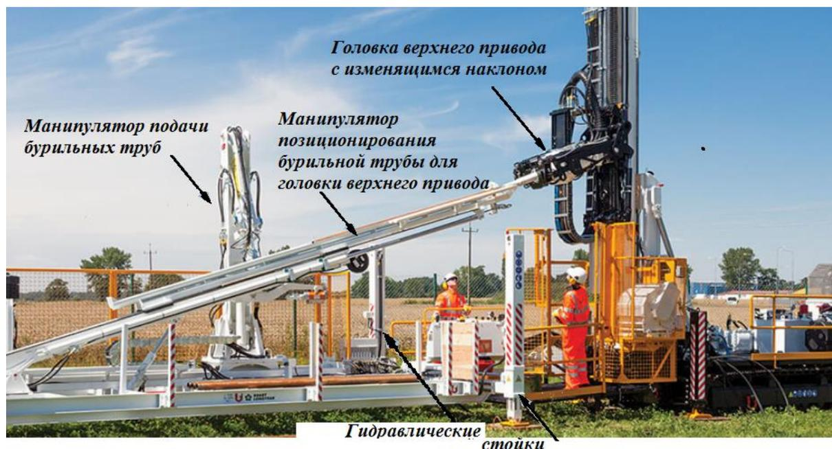
**Рисунок 1.** Роботы (манипуляторы) в автоматизированных буровых установках FL262 FREEDOM™ Loader and LF™160 Surface coring drill rig фирмы Boart Longyear.
