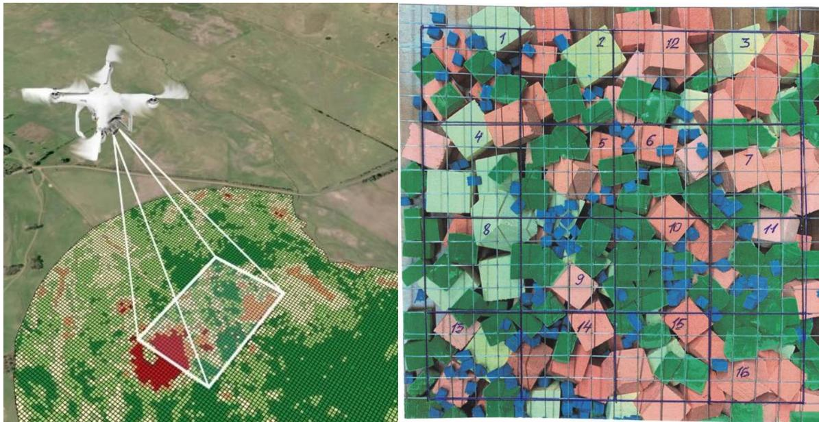
**Рисунок 1.** Квадрокоптер в полете с масштабированной сеткой (слева) и сделанный им снимок на развале горных пород (справа).
